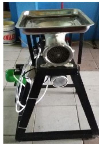
Gambar 9. Mesin Pelet Ikan Tampak Depan
